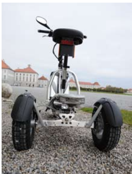
Stand sicher: Die 60 cm breite Hinterachse sorgt für gute Bodenaufgabe und Sicherheit für Menschen mit Handicap
