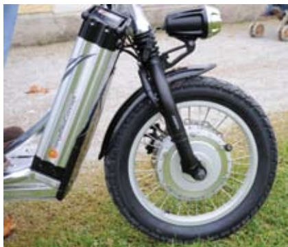
Leistungsstark: Der Elektromotor in der Vorderradnabe und die zwei in Serie geschalteten Akkus
