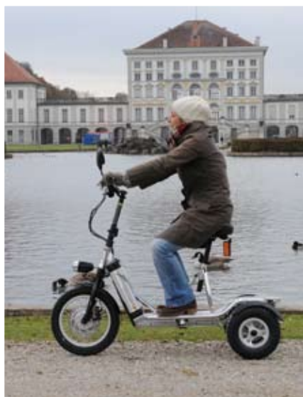
Stand sicher: Die 60 cm breite Hinterachse sorgt für gute Bodenaufgabe und Sicherheit für Menschen mit Handicap
